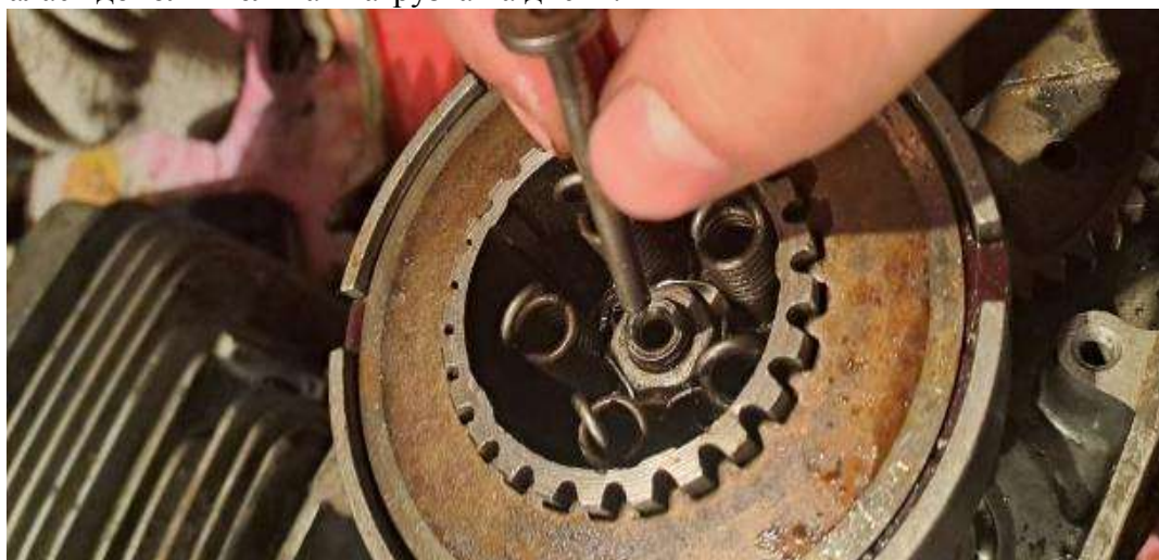
Рис. 8 - Установка выжимного грибка
