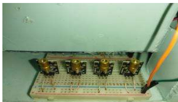
Рис. 4 Макетная плата с подключенными лазерами
