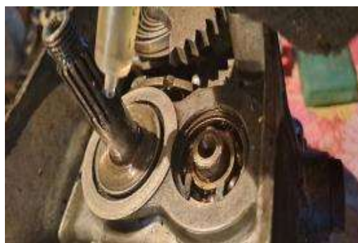
Рис. 4 – Смазка и установка втулки
