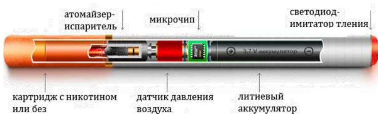
Рис. 1. – Устройство вейпа
