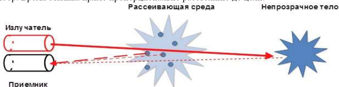
Рис. 1.- Принцип действия лидара
