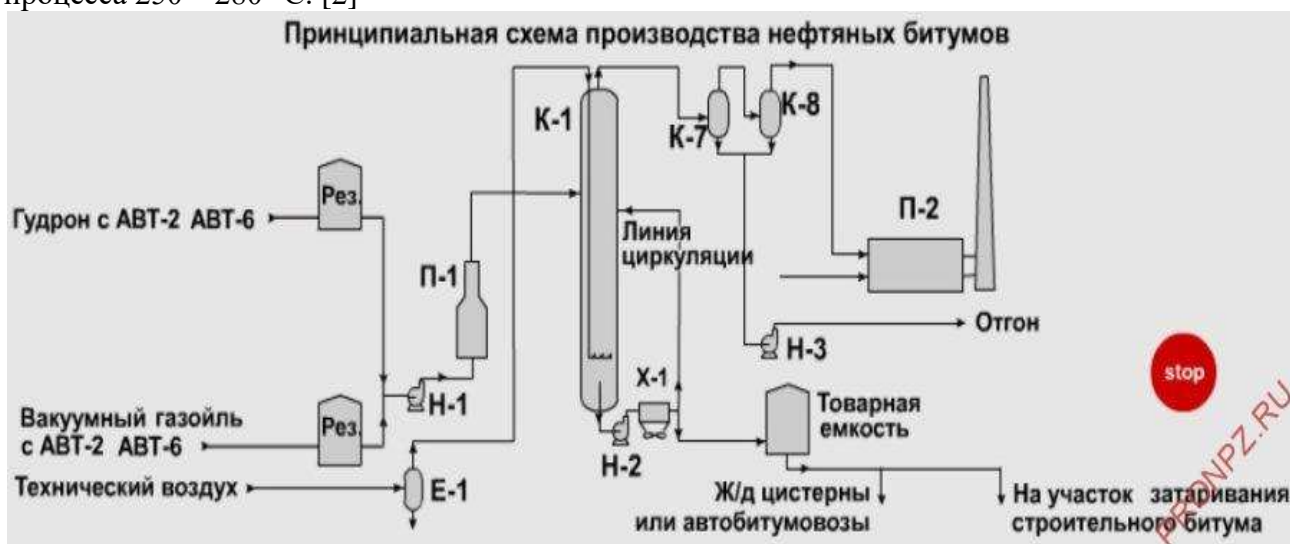
Рис.1.- Принципиальная технологическая схема битумной установки
