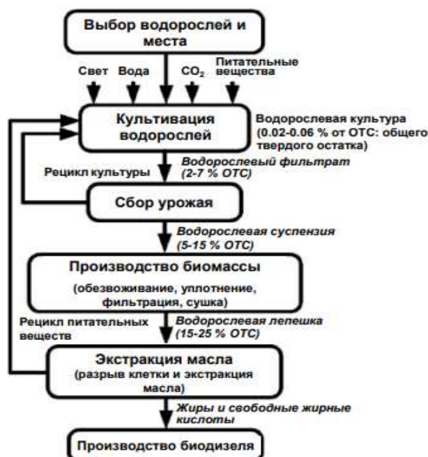
Рис. 1. – Этапы получения биодизеля из водорослей
