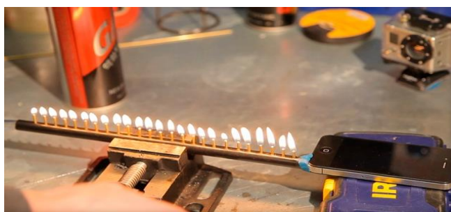
Рис. 4 – Устройство Трубы Рубенса
